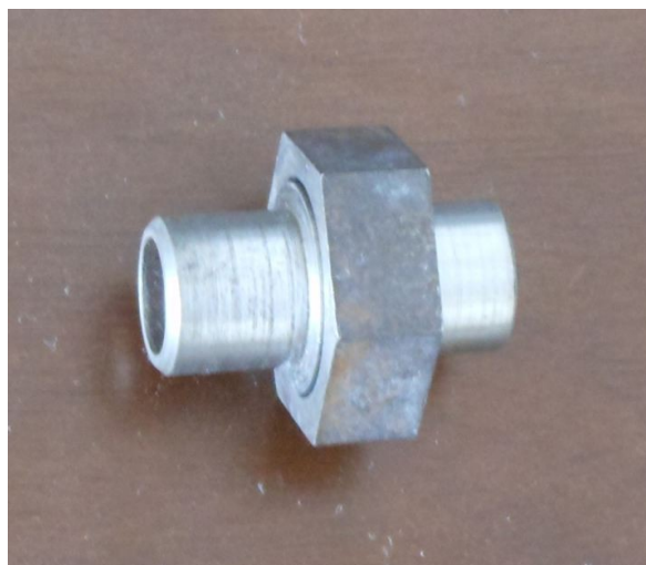
FIGURA 8.4 Montagem com duas superfícies externas do cilindro encaixadas.
