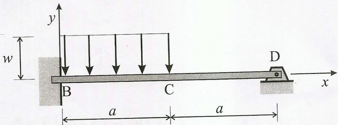
1. Calcular a reação  $R$  do apoio em D, em função de  $a$  e  $w$ .
