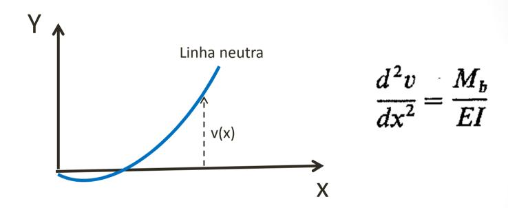
A configuração deformada da viga é definida completamente pela posição da linha neutra, ou seja pela função v(x) (seções transversais permanecem planas e ortogonais à linha neutra)
